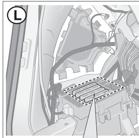
Sicherungskasten B rot / Fusebox B red
